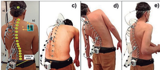
Figura 1. (a) Sistema basado en MIMU. (b) Marco de referencia de los sensores; movimientos considerados en el análisis de reducción de información. (c) Flexión anterior de la cadera. (d) Flexión lateral del tronco. (e) Rotación axial del tronco. (DC25)
